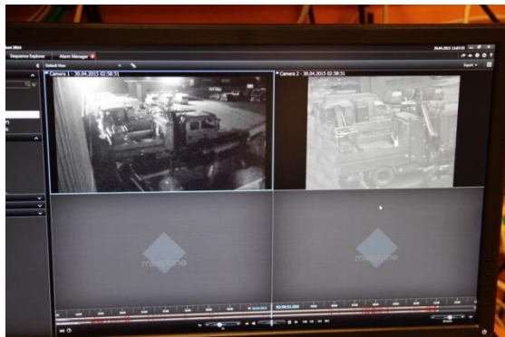
IP kamera til venstre, termisk kamera til høyre.
